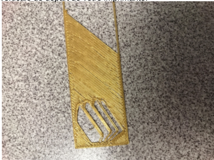
Ci-dessus : Une mauvaise première couche causée par un problème de décalage Z. La distance entre la plaque et la buse est trop élevée. Source : mrbnatural10 sur les concentrateurs 3D
