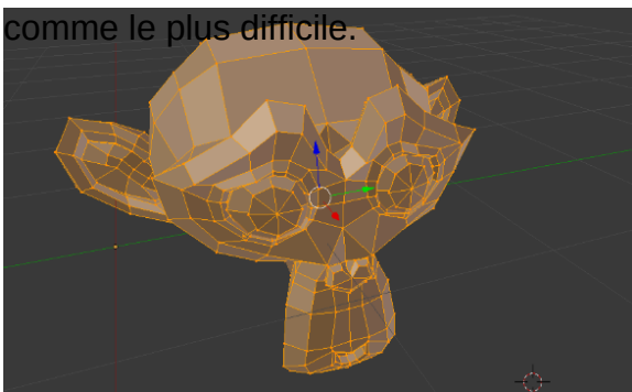
Ci-dessus : Vue du programme Blender. Le singe est composé de sommets qui forment des arêtes et de faces quadrilatérales/trilatérales.
